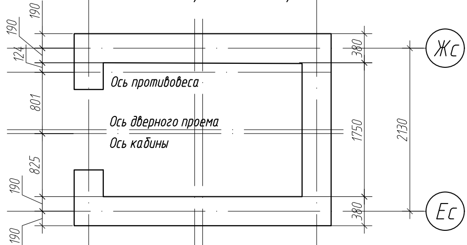
План шахты лифта на отм. 0,000
